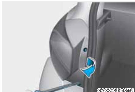
4. Uklonite utičnicu iz sklopa okretanjem utičnice u smeru suprotnom od kretanja kazaljke na satu dok se žlebovi na utičnici ne poravnaju sa urezima na sklopu.
