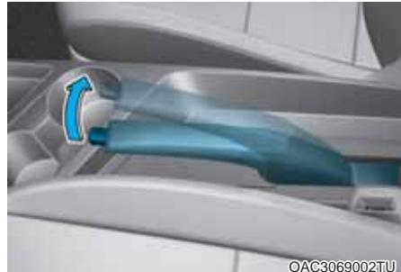
Proverite hod parkirne kočnice brojanjem "klikova" koje čujete dok je aktivirate iz potpuno otpuštenog položaja. Takođe, sama kočnica treba čvrsto da osigurava vozilo na strmom usponu. Ako je hod manji ili veći od navedenog, preporučujemo da sistem servisirate kod ovlašćenog HYUNDAI distributera.
