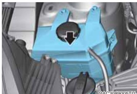
Proverite stanje i spojeve svih rashladnih cevi sistema i creva grejača. Zamenite sve natečene ili oštećene cevi i creva.
