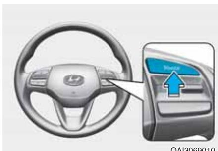
**Prvo, prebacite u način Tempomata pritiskom dugmeta MODE ako je vozilo opremljeno Sistemom za kontrolu ograničenja brzine.**
