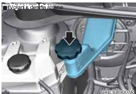
Povremeno proverite nivo tečnosti u rezervoaru. Nivo tečnosti mora biti između oznaka MAX i MIN na strani rezervoara.
