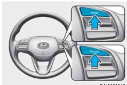
1. Gurnite CRUISE/ $\text{MODE}$ dugme na volanu da biste uključili sistem. Indikator tempomata  $\text{MODE}$  će svetleti na LCD ekrani.
