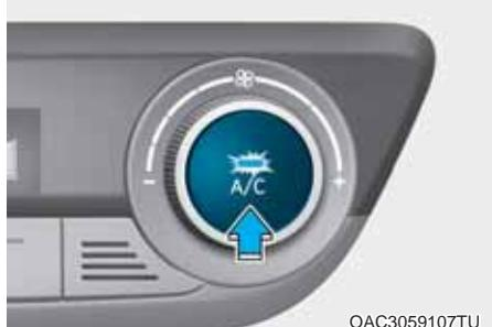
Pritisnite A/C dugme da biste ručno uključili sistem za klimatizaciju (indikator lampica će svetleti). Pritisnite dugme ponovo da biste isključili sistem za klimatizaciju.
