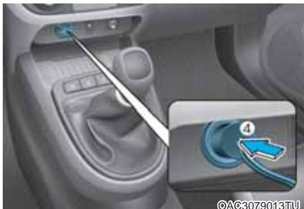
5. Utaknite električni kabl kompresora (4) u električnu utičnicu vozila.
