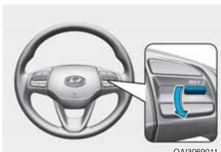
3. Pritisnite prekidač dole(SET-) i i otpustite ga. Podešena brzina će svetleti na LCD ekranu.
