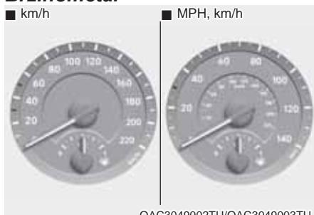
Brzinometar pokazuje brzinu vozila i kalibriran je u kilometrima na sat (km/h) i/ili miljama na sat (MPH).
