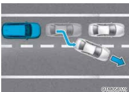
Kada vozite u kreni-stani uslovima i zaustavljeno vozilo ispred vas napusti traku, FCA sistem neće odmah detektovati novo vozilo koje je sada ispred vas. U ovom slučaju morate održavati bezbednu kočionu udaljenost i ako je neophodno pritisnuti papučicu kočnice kako biste smanjili brzinu u cilju održavanja bezbedne razdaljine.
