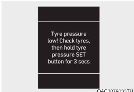
Ova poruka upozorenja se prikazuje ako je pritisak u gumi nizak. Guma sa niskim pritiskom na vozilu će biti osvetljena.
