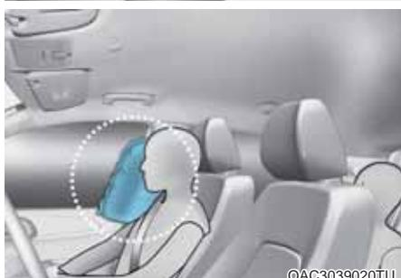
Vaše vozilo je opremljeno bočnim vazdušnim jastukom za svako prednje sedište.
