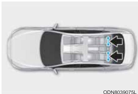
ISOFIX konektori se nalaze na bočnom levom i desnom zadnjem sedištu. Njihov položaj je prikazan na slici. Ne postoji obezbeđen ISOFIX priključak za zadnje centralno sedište.
