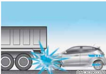
Neposredno pre udara, vozači jako zakoče. Takva jaka kočenja snižavaju prednji deo vozila što uzrokuje da vozilo ode pod više vozilo. Vazdušni jastuci se ne mogu naduvati u ovoj situaciji "podvlačenja" zbog usporavanja snage, koja je otkrivena od strane senzora i koje značajno mogu smanjiti snagu sudara.
