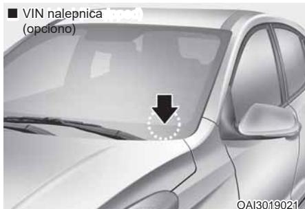
VIN se takođe nalazi na pločici pričvršćenoj na vrhu komandne table. Broj na tabli se spolja lako može videti kroz vetrobransko staklo.
