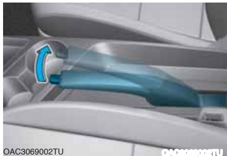
Uvek povucite parkirnu kočnicu pre napuštanja vozila, da biste to učinili. Čvrsto pritisnite papučicu kočnice. Povucite ručicu parkirne kočnice koliko je to moguće.
