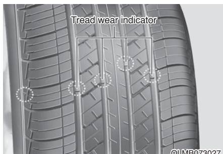
Ako je guma istrošena ravnomerno, indikator istrošenosti pojaviće se na profilu gume u obliku ravnomerne trake. To pokazuje da je ostalo manje od 1,6 mm (1/16 inča) omotača na gumi. Zamenite gumu kada se to dogodi.
