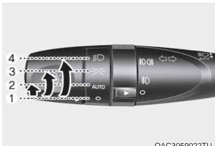
Za rad sa svetlima okrenite prekidač na kraju kontrolne ručice u sledeće položaje:
