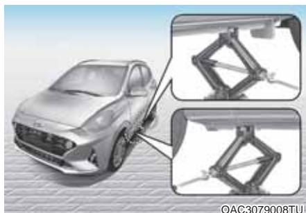
7. Postavite dizalicu na položaj predviđen za to, ispod okvira najbliže gumi koju menjate. Položaji dizalice su ploče zavarene za okvir s dva ureza. Nikada ne stavljajte dizalicu na bilo koji drugi položaj ili deo vozila. To može oštetiti vozilo.
