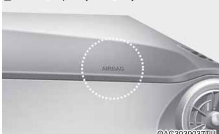
Vaše vozilo je opremljeno Dodatnim Sigurnosnim Sistemom (SRS) i krilnim/ ramenim pojasevima na vozačevom i suvozačevom sedištu. SRS se sastoji od vazdušnih jastuka koji se nalaze u sredini volana, na vozačevoj strani na donjoj površini volana i sa suvozačeve strane na prednjoj konzoli iznad kasete za rukavice.
