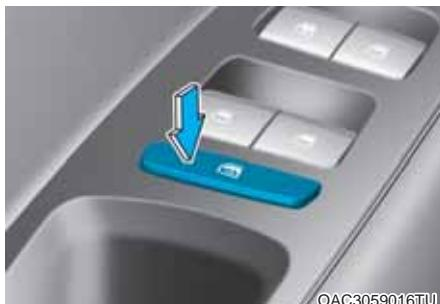
Vozач može da onemogući rad prekidača električnih prozora putnicima na zadnjim vratima pritiskom na prekidač blokade električnih prozora.
