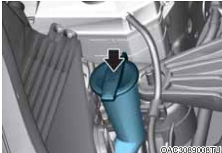
Proverite nivo tečnosti u rezervoaru tečnosti za pranje stakala i sipajte tečnost ako je potrebno. Ako nemate tečnost, sipajte čistu vodu. Ipak, zimi upotrebljavajte tečnost sa antifriz osobinama kako biste sprecili smrzavanje tečnosti.
