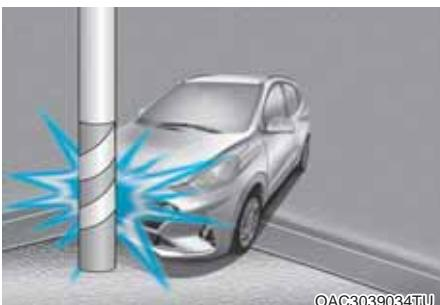
Vazdušni jastuci se možda neće naduvati ako se vozilo sudari s predmetima kao što su komunalni stubovi ili drveće, gde je tačka udara koncentrisana i struktura vozila apsorbuje energiju sudara.
