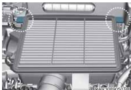
5. Proteza u filteru treba da bude montirana bilo s leve bilo s desne strane gornjeg dela filtera za vazduh. Ako je nepravilno instaliran prema donjoj strani, može biti teško za sklapanje.
