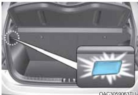
Svetlo prtljažnog prostora se pali kada se otvore vrata prtljažnika.
