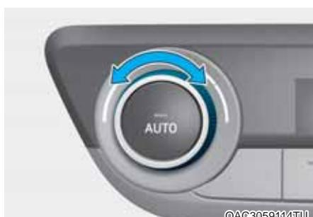
2. Okrenite dugme za kontrolu temperature na željenu temperaturu. Ako je temperatura podešena na najniže (Lo), sistem za klimatizaciju će raditi neprekidno.
