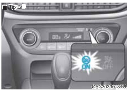
Da biste ponovo aktivirali suvozačev prednji vazdušni jastuk: Ubacite ključ ili sličan čvrst predmet u ON/OFF prekidač suvozačevog prednjeg vazdušnog jastuka i okreniti ga u ON položaj. ON indikator prednjeg (
