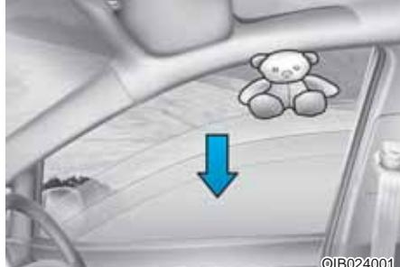
Ako prozor oseti nekakvu prepreku dok se automatski zatvara, zaustaviće se i spustiti za oko 30 cm (12 inči) kako bi dozvolio da se objekat ukloni.
