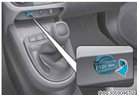
Električna utičnica dizajnirana je kako bi snabdela energijom mobilne ili druge uređaje dizajnirane za korišćenje električnog sistema vozila.
