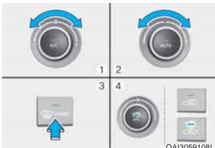
1. Izaberite željenu brzinu ventilatora.
