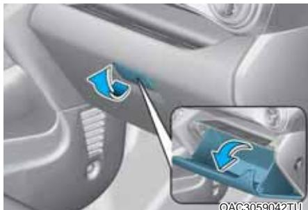
Da biste otvorili kasetu za rukavice povucite ručicu i kasetu za rukavice će se automatski otvoriti. Zatvorite kasetu za rukavice posle upotrebe.
