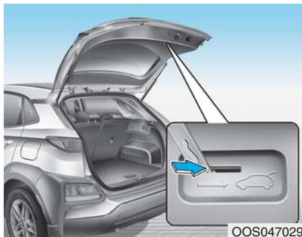
Vaše vozilo je opremljeno sigurnosnom ručicom za otvaranje vrata prtljažnika u hitnim slučajevima, koja se nalazi na dnu prtljažnika. Kada je neko slučajno zaključan u prtljažniku, vrata se mogu otvoriti i treba da postupite na sledeći način:
