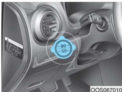
**Odvojite nalepnicu za ograničenje brzine (0) sa boce sa sredstvom za lepljenje (1), i stavite je na vrlo vidljivo mesto u vozilu, kao što je volan, kako bi se vozač podsetio da ne vozi prebrzo.**
