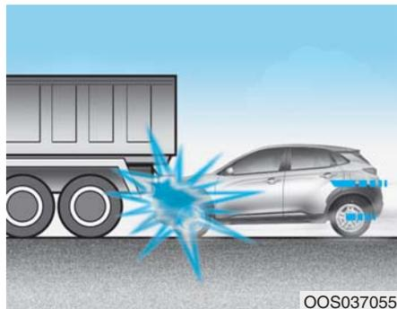
Neposredno pre udara, vozači jako zakoče. Takva jaka kočenja snižavaju prednji deo vozila što uzrokuje da vozilo ode pod više vozilo. Vazdušni jastuci se ne mogu naduvati u ovoj situaciji “podvlačenja” zbog usporavanja snage, koja je otkrivena od strane senzora i koje značajno mogu smanjiti snagu sudara.
