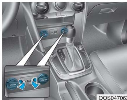
Ova utičnica dizajnirana je kako bi snabdela energijom mobilne ili druge uređaje dizajnirane za korišćenje električnog sistema vozila.
