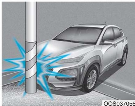
Vazdušni jastuci se možda neće naduvati ako se vozilo sudari s predmetima kao što su komunalni stubovi ili drveće, gde je tačka udara koncentrisana i struktura vozila apsorbuje energiju sudara.
