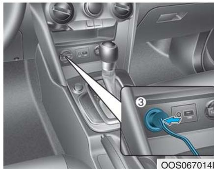
7. Spojite kompresor u utičnicu vozila (3) pomoću kabla i konektora.
