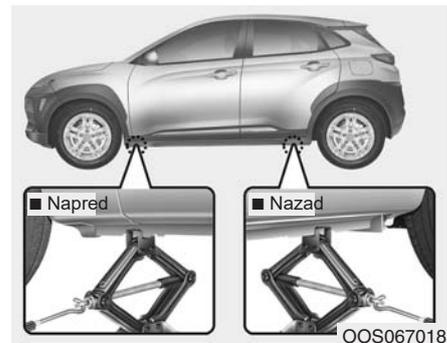
7. Postavite dizalicu na položaj predviđen za to, ispod okvira najbliže gumi koju menjate. Položaji dizalice su ploče zavarene za okvir s dva ureza. Nikada ne stavljajte dizalicu na bilo koji drugi položaj ili deo vozila. To može oštetiti vozilo.
