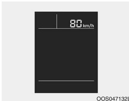
Ova poruka prikazuje brzinu vozila kada je digitalni brzinometar uključen.
