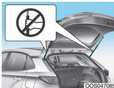
Ne držite rukom deo (gasni podizač) koji je potpora prtljažnika. Znajte da deformacija ovog dela može uzrokovati oštećenja vozila i nesreću.
