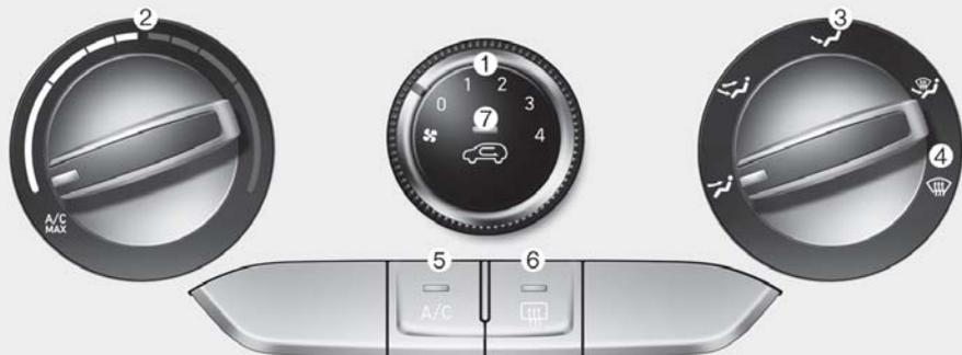
1. Prekidač za kontrolu brzine ventilatora
