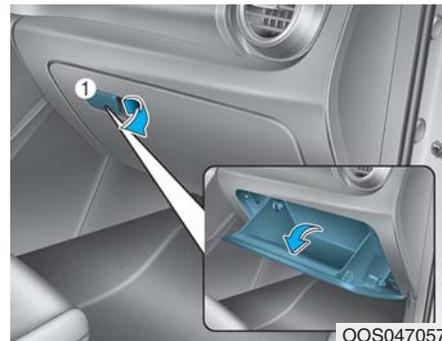
Da biste otvorili kasetu za rukavice povucite ručicu (1) i kasetu za rukavice će se automatski otvoriti. Zatvorite kasetu za rukavice posle upotrebe.
