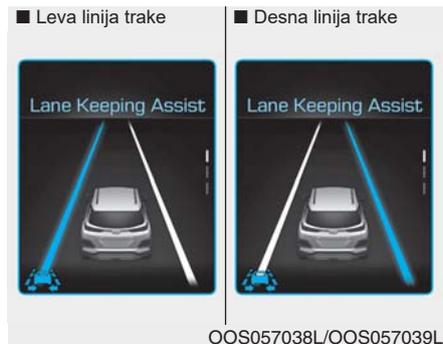
Pojavljuje se vizuelno upozorenje na LCD displeju instrument table. Leva ili desna linija trake na LCD displeju instrument table će treptati u zavisnosti u kom pravcu skrenulo vaše vozilo.
