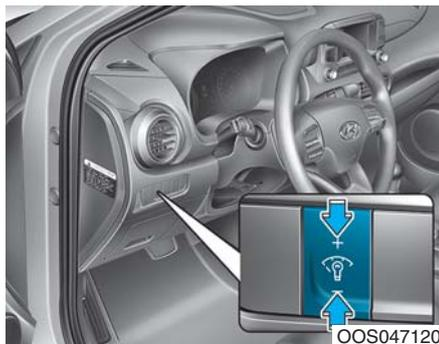
Kada su parking svetla i prednja svetla vozila uključena, pritisnite dugme za kontrolu osvetljenja da biste podesili osvetljenje instrument table.
