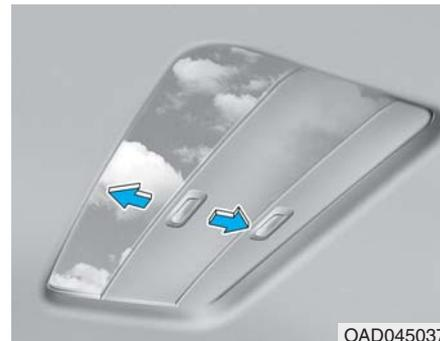
Štitnik za sunce će se automatski otvoriti sa panoramskim krovom kada se stakleni panel pomeri. Ako želite da ga zatvorite, pomerite štitnik za sunce ručno.
