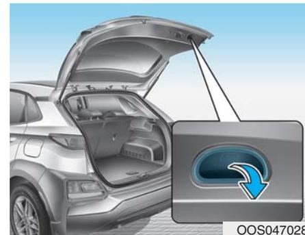
Spustite vrata prtljažnika i pritisnite dole dok se ne zaključaju. Da biste bili sigurni da su se vrata prtljažnika dobro zatvorena, uvek proverite pokušavanjem da podignete vrata bez pritiskanja dugmeta na ručici prtljažnika.
