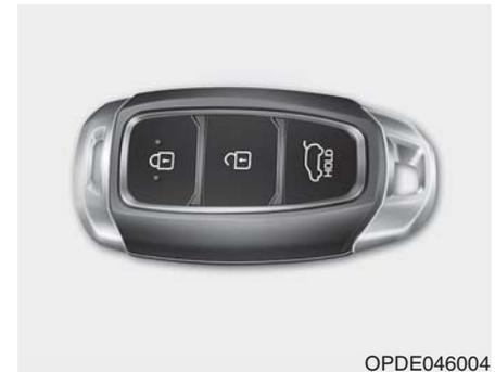
Za zaključavanje vrata, pritisnite dugme na spoljnoj ručici noseći pametni ključ sa sobom ili pritisnite taster za zaključavanje vrata na pametnom ključu.
