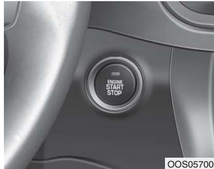
Kad god su prednja vrata otvorena, prekidač motora Start / Stop će svetleti i ugasiće se 30 sekundi nakon zatvaranja vrata.
