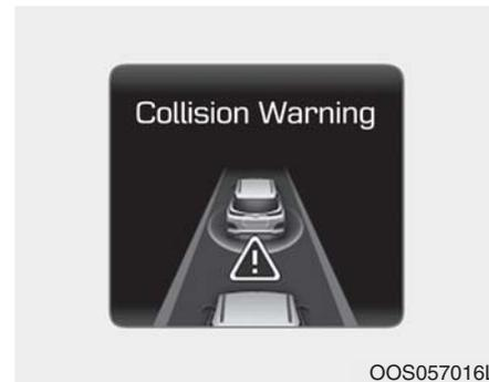
Ova poruka upozorenja se pojavljuje na LCD displeju sa zvučnim signalom. Pored toga, desiće se neki sistemi intervencije vozila kojima upravlja sistem upravljanja motorom da bi pomogli u usporavanju vozila.
