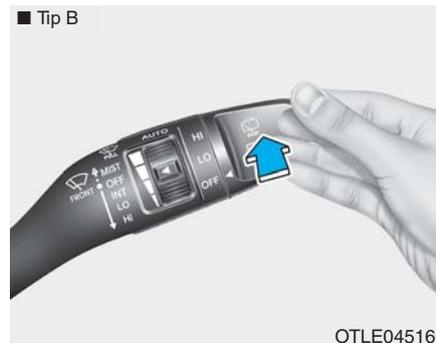
Pomerite ručicu dalje od sebe da biste rasprskali tečnost za pranje na zadnje staklo i da bi zadnji brisač zamahnuo 1-3 puta. Rad prskalice i brisača će se nastaviti dok ne otpustite ručicu. (opciono)
