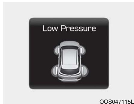
Ova poruka upozorenja se prikazuje ako je pritisak u gumi nizak. Guma sa niskim pritiskom na vozilu će biti osvetljena.
