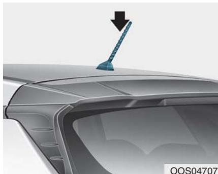
Krovna antena prima prenosne podatke. (Na primer: AM/FM, DAB, GPS/GNSS)
