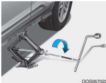
8. Umetnite ručicu dizalice u dizalicu i okrenite suprotno od smera kazaljke na satu podižući auto dok se guma ne odvoji od tla. Proverite da li je automobil stabilan na dizalici.
