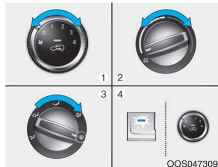
1. Izaberite bilo koju brzinu ventilatora, osim "0" položaja.
