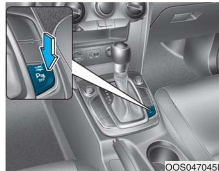
Pritisnite dugme da biste isključili Sistem upozorenja na udaljenost pri parkiranju (rikverc). Indikator lampica na dugmetu će se upaliti.
