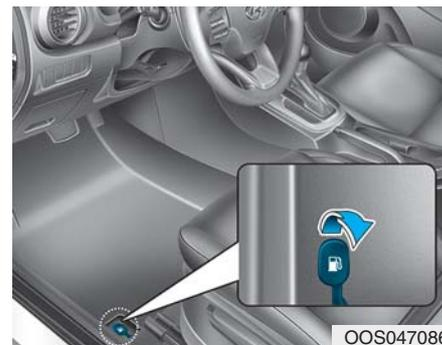
Vrata otvora za sipanje goriva se moraju otvoriti iz unutrašnjosti vozila, povlačenjem otvarača za rezervoar goriva.
