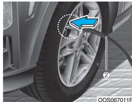
4. Odvrite kapicu ventila sa ventila neispravnog točka i zategnite crevo (2) boce sredstva za zaptivanje na ventil.
