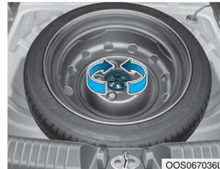
Okrenite sigurnosni vijak u smeru suprotnom od kazaljke na satu da biste izvadili rezervnu gumu. Vratite rezervnu gumu na mesto okretanjem sigurnosnog vijka u smeru kazaljke na satu. Da biste sprečili "zveckanje" rezervne gume i alata dok je vozilo u pokretu, spakujte ih pravilno i na njihovo mesto.
