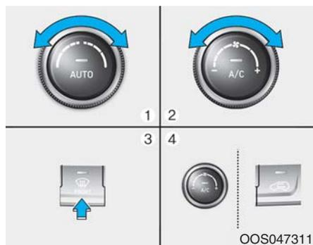
1. Izaberite žaljenu brzinu ventilatora.
