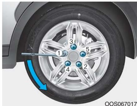
6. Otpustite matice točka u smeru suprotnom od kretanja kazaljke na satu jedan okret prema redosledu prikazanom gore, ali ne uklanjajte sve matice dok guma nije podignuta sasvim od zemlje.
