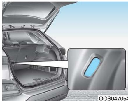
Svetlo prtljažnog prostora se pali kada se otvore vrata prtljažnika.
