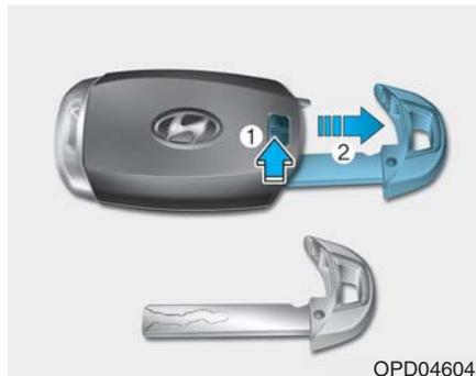
Pritisnite i držite taster za otpuštanje (1) i uklonite mehanički ključ (2). Umetnite mehanički ključ u otvor za ključ na vratima. Da biste ponovo postavili mehanički ključ, stavite ključ u otvor i gurnite ga dok se ne čuje zvuk klik.
