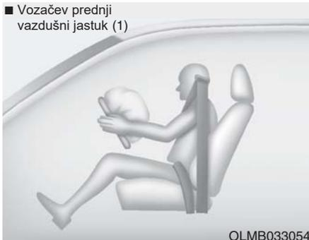
Kada SRSCM detektuje dovoljno jak udar na prednjem delu vozila, automatski će naduvati prednje vazdušne jastuke.
