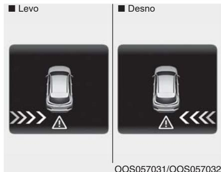
Ako vozilo koje su detektovali senzori prilazi vašem vozilu, zvučni signal upozorenja će se oglasiti, lampica upozorenja na spoljnom retrovizoru će treptati i poruka upozorenja će se prikazati na LCD displeju.
