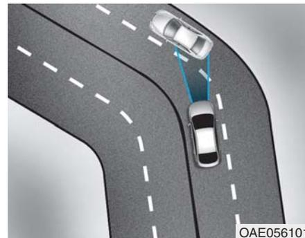
FCA sistem možda neće prepoznati vozilo u susednoj traci kada vozite na krivudavom putu.
