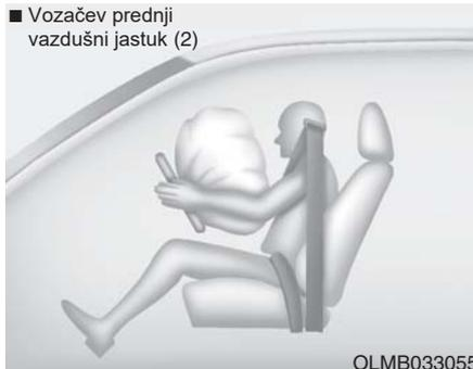
Nakon aktivacije, šavovi poklopca će se odvojiti pod pritiskom širenja vazdušnih jastuka. Dalje otvaranje poklopca omogućuje potpuno naduvavanje vazdušnih jastuka. Potpuno naduvani vazdušni jastuk, u kombinaciji s pravilno vezanim pojasom, usporava vozačevo ili suvozačevo pomeranje prema napred, smanjujući rizik od povrede glave i grudnog koša.
