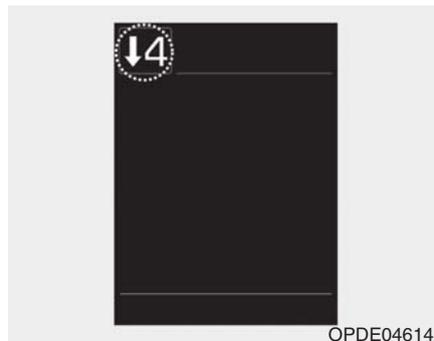
U ručnom načinu prenosa brzina ovaj indikator vas obaveštava koja je željena brzina vožnje radi uštede goriva.
