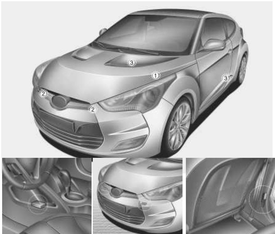
**Senzori za detekciju udara**
