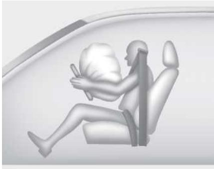
Nakon aktiviranja, šavovi na centralnoj plo i kola upravlja a e se razdvojiti pod pritiskom usled ekspanzije vazdušnih jastuka dalje otvaraju i poklopac što e omogu iti potpuno naduvavanje vazdušnih jastuka
