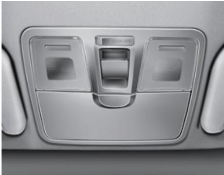
Ukoliko je vaše vozilo opremljeno krovnim prozorom, možete ga pomerati klizanjem ili izdizati zadnji deo a sve pomoću kontrolnog dugmeta koje se nalazi na krovnom panelu, kada je kontakt ljuč u ON položaju.
