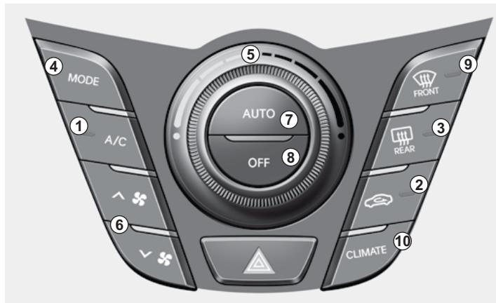
1. Prekidač uklj./isklj. uređaja za klimatizaciju
