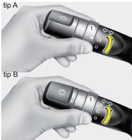
Da date signal svetlosnom sirenom, tzv ablendovali prednjim svetlima, obrtni cilindar povucite ka sebi i zatim odspusnite-svetla će se vratiti u položaj oborena svetla.
