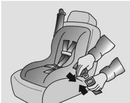
2 . Stavite šnalu, metalni deo pojasa u kop pukotinu dok ne ujete zvučno "klik". Zategnite pojaz. Postavite dugme za skidanje, otkopavanje pojasa na mesto do koga je lako dobru službu opasnosti.
