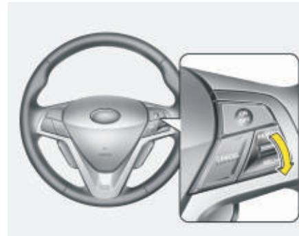
3. Pritisnite prekidač -/SET i otpustite ga. Lampica SET na instrument tabli će zasvetleti. Odpustite papučicu gasa u isto vreme. Željena brzina će se automatski odžavati.
