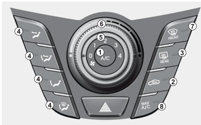
1. Prekidač uklj./isklj. uređaja za klimatizaciju
