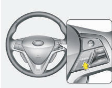
Svaka od ovih radnji će isključiti sistem za podešavanje krstareće brzine u vožnji (lampica SET na instrument tabli će se isključiti), ali ovo neće isključiti sistem. Ako želite da vrattie sistem na prethodno podešenu vrednost, tada pritisnite dugme RES+ na kolu upravljača.
