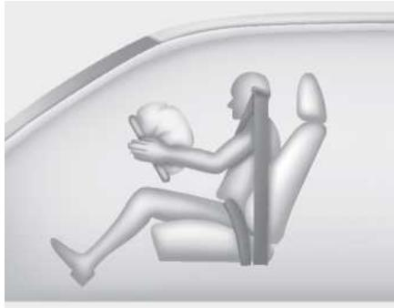
Moduli vazdušnog jastuka se nalaze i u sredini kola upravlja a i u prednjem panelu table s instrumentima, iznad kasete za sitnice kod suvoza a. SRSCM detektuju ja i udar na prednjem delu vozila, prednji vazdušni jastuci se automatski naduvaju
