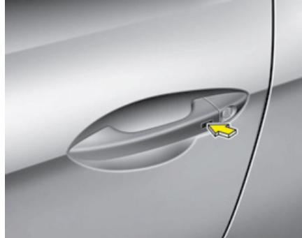
Pritiskom na dugmad koja se nalaze na ručkama svih vrata (i prtlažnika) sa spoljašnje strane, kada su sva vrata zatvorena i zaključana, automatski se otključavaju sva vrata i prtlažnik. Signalno svetlo upozorenja (sva četiri migavca) će zasvetleti i čuće se prateći zvuk jednom što označava da su sva vrata i prtlažnik zaključana. Dugme će raditi samo ako se ""smart"" ključ nalazi na udaljenosti od 0.7~1 m od ručke na vratima.
